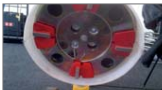
Fyra diamantsegment som är enkelt att utbyta utan verktyg
