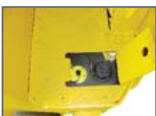
Diesel tanken är skyddad under fotplattan
