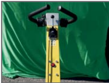
Hydraulisk pump i handtaget
