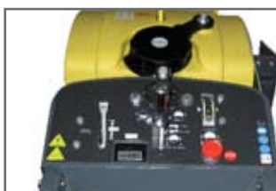
Kontrollpanel med elektronisk mätare för arbetstimmar
