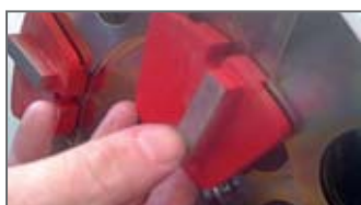
Sidoskydd vilket förhindrar dammspridning
