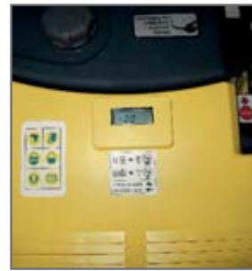
Elektronisk mätare som registrerar arbetstimmar och motorvarv
